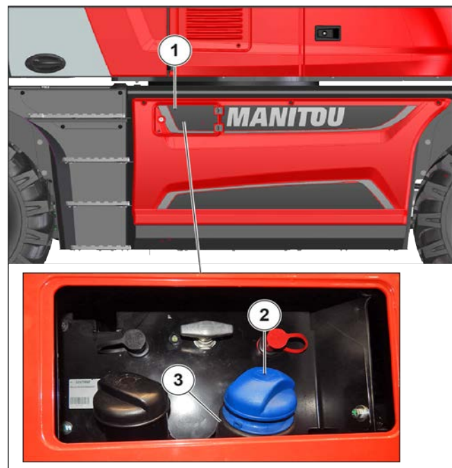
Afbeelding 149: Het peil van de DEF-vloeistof controleren
